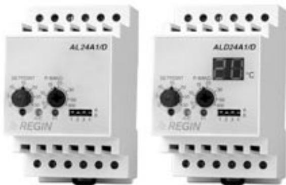
AL24A1/D имеет один выходной сигнал в диапазоне 0...10 В. Терморегулятор предназначен для управления обогревом или охлаждением в системах отопления, вентиляции и кондиционирования воздуха. Он имеет малые размеры и предназначен для монтажа на DIN-рейке.
