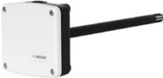
Терморегулятор AL24A1K предназначен для крепления в воздуховоде. Имеет встроенный термодатчик, а также выходной сигнал в диапазоне 0...10 В. Терморегулятор предназначен для управления обогревом или охлаждением в системах отопления, вентиляции и кондиционирования воздуха.
