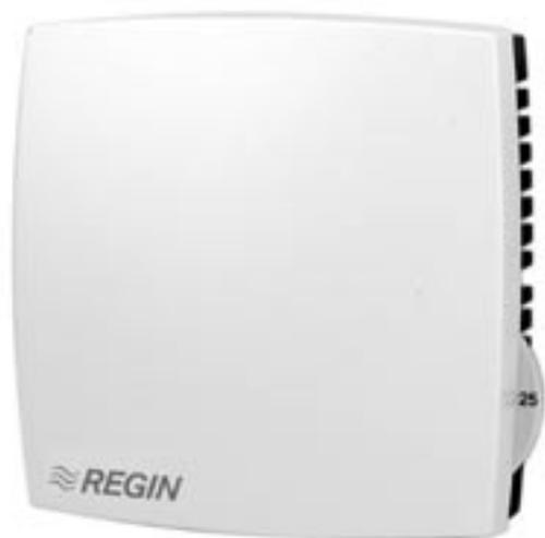
Комнатный терморегулятор AL24A2 со встроенным термодатчиком и двумя выходными сигналами в диапазоне 0...10 В. Терморегулятор предназначен для управления обогревом или охлаждением в системах отопления, вентиляции и кондиционирования воздуха.
