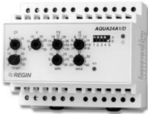
AQUA24A1/D представляет собой П и ПИ регулятор, предназначенный для регулирования температуры воздуха в помещении или температуры приточного воздуха в системах отопления, вентиляции и кондиционирования. Терморегулятор имеет малые размеры и предназначен для монтажа на DIN-рейке.
