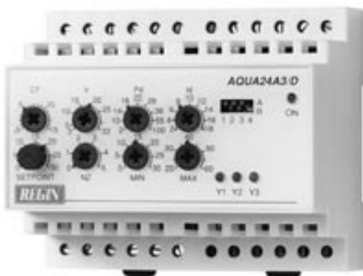
AQUA24A3/D представляет собой П- и ПИ- регулятор и предназначен для регулирования температуры воздуха в помещении или температуры приточного воздуха в системах отопления, вентиляции и кондиционирования. Терморегулятор имеет малые размеры и предназначен для монтажа на DIN-рейке.
