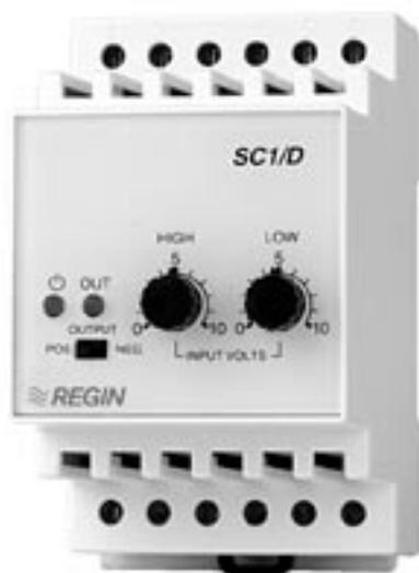
Преобразователь сигнала SC1/D серии AQUALINE преобразует входной сигнал, изменяющийся в диапазоне 0...10 В, в выходной релейный сигнал Вкл/Откл. Преобразователь SC1/D может быть настроен на прямое или инверсное действие. Уровни сигнала на включение и отключение можно настраивать индивидуально.
