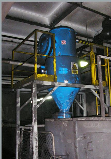
Стационарная вакуумная система с прямой выгрузкой собранного материала на ленточный конвейер.
