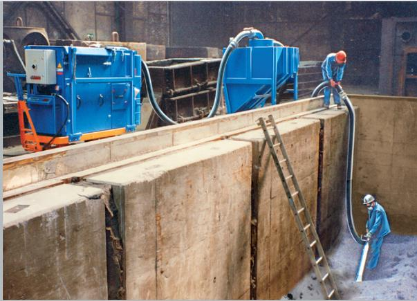
Эффективная и качественная зачистка трюмов и отсеков судов после механической и дробеструйной обработки от значительного количества дроби и окалины, перед последующей окраской, перед началом монтажа электрических кабелей, трубопроводов, специального оборудования и т.п.
