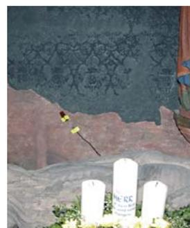
Датчик температуры поверхности, на настенной фреске.
