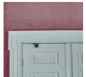
Фотоячейка отражения, для регистрации положения двери. Фирма Fiessler.
