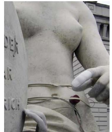
Измерение температуры поверхности с помощью NTC датчика температуры FN 0001. Датчик влажности FHA 646 R в специальном корпусе для микроклиматических измерений.
