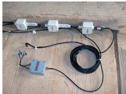
Деревянный кессонный потолок с установленными датчиками, кабель-удлиннитель и розетка
