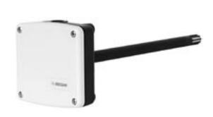
Терморегулятор AL24A1К предназначен для крепления в воздуховоде. Имеет встроенный термодатчик, а также выходной сигнал в диапазоне 0...10 В. Терморегулятор предназначен для управления обогревом или охлаждением в системах отопления, вентиляции и кондиционирования воздуха.
