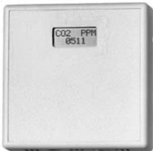
CO2RT представляет собой комнатный преобразователь для измерения содержания двуокиси углерода. В нем используется запатентованная измерительная система с источником инфракрасного излучения и эталонной камерой, что обеспечивает высокую долговременную стабильность характеристик.
