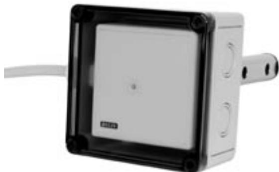
CO2DT представляет собой воздуховодный преобразователь для измерения содержания двуокиси углерода. В нем используется запатентованная измерительная система с источником инфракрасного излучения и эталонной камерой, что обеспечивает высокую долговременную стабильность характеристик.
