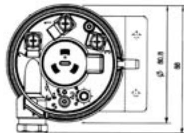
Штуцер P1 для подключения высокого давления
