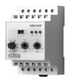
HD2-24/D представляет собой электронный гигростат, для регулирования влажности в системах отопления, вентиляции и кондиционирования воздуха. Гигростат подключается к преобразователю влажности с аналоговым выходным сигналом 0...10 В.
