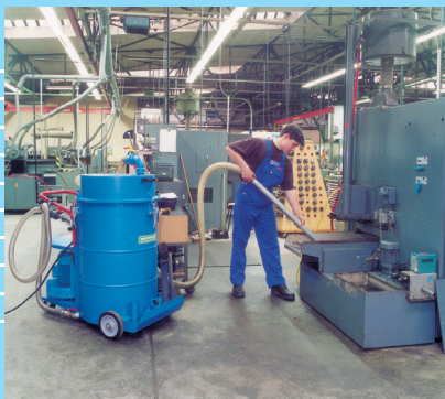
Уборка производственного оборудования, сепарация СОЖ от металлической стружки
