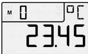
Отображение измеренного значения, канал M0, температура
