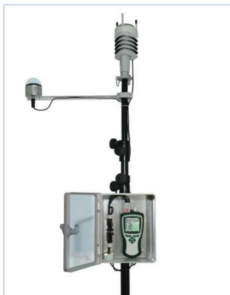
Универсальная портативная переносная метеостанция для измерения широкого спектра метеорологических данных: направление ветра, скорость ветра, отн. влажность, температура и давление воздуха, количество и интенсивность осадков, глобальная радиация. Станция проста в разворачивании и работе, имеет прочную конструкцию и многообразие вариантов питания (аккумуляторы, солнечные батареи, автомобильный адаптер питания).
