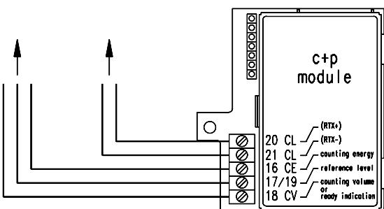
В комбинированном модуле реализованы функции импульсного модуля (зажимы 16,17,18) и модуля CL (зажимы 19, 20, 21). Обратите внимание, что относительные потенциалы 17, 19 выведены на общий зажим.
