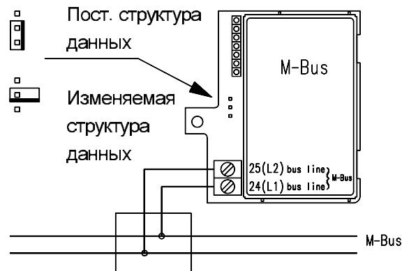
**Данные с постоянной структурой** (кодирующий штекер установлен вертикально):
