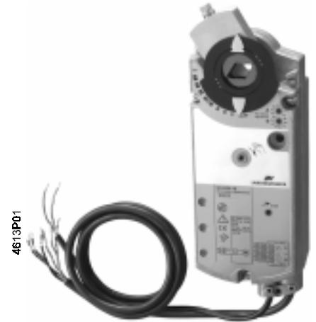
**Электрические приводы с номинальным крутящим моментом 16 Нм, с пружинным возвратом в безопасное положение, рабочим напряжением 24 или 230 в переменного тока, двухпозиционным регулятором, механической регулировкой угла поворота от 0 до 90°, оборудованы соединительными кабелями длиной 0.9 м. Имеются специальные типы приводов с регулируемыми вспомогательными переключателями для дополнительных функций.**
