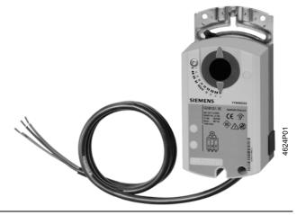
Электрические приводы с номинальным вращательным моментом 5/10 Нм, рабочим напряжением 24 или 230 В переменного тока, трехпозиционным управлением, механически регулируемым углом поворота в пределах от 0 до 90°, оборудованы соединительными кабелями длиной 0,9 м. Выпускаются типы приводов с регулируемыми вспомогательными переключателями для дополнительных функций, а также с потенциометром для индикации положения.
