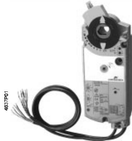
**Привод электрический, с номинальным крутящим моментом 16 Нм, пружинным возвратом, рабочим напряжением 24 В переменного тока, управляющим сигналом постоянного тока 0...10 В, сигналом обратной связи 0...10 В постоянного тока для индикации положения, механически регулируемым углом вращения в пределах от 0 до 90°, оснащен соединительными кабелями длиной 0,9 м.**
