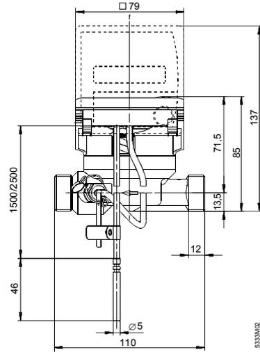
Глубина монтажа 110 мм,
