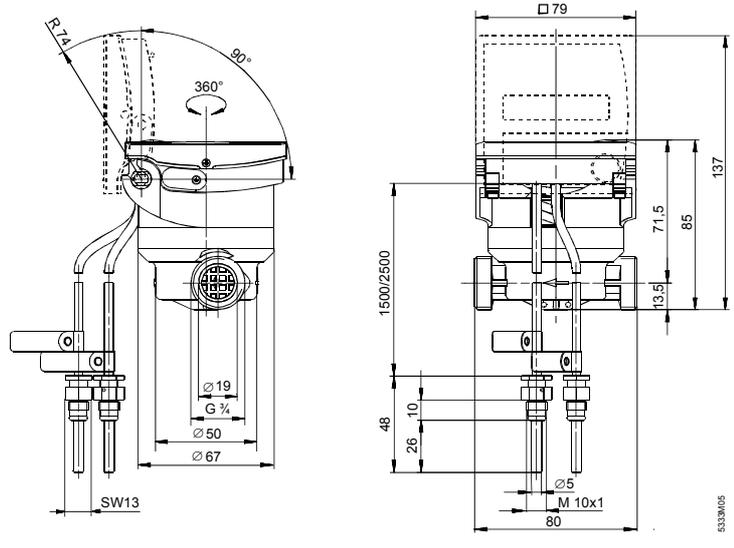
Глубина монтажа 80 мм,
