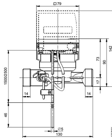
Глубина монтажа 130 мм,
