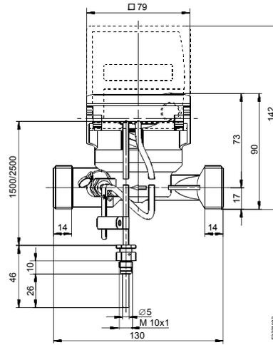
Глубина монтажа 130 мм,
